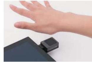
注：静脈認証方法について 手のひら静脈センサーを使用して静脈認証をおこなうには、あらかじめ静脈情報を登録しておく必要があります。センサーの発光部から出た近赤外線を手にかざし、その散乱光をセンサーの受光部で読み取ることで、手のひら内部の静脈情報を読み出します。センサーにかざした手の静脈情報と、事前に登録された静脈情報が一致すると認証が完了します。
