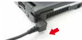
コネクタ部の耐久性を確認するため、ACアダプター、USB、PCカードなどの各種インターフェースに対し、コネクタ挿抜の繰り返しや、大きな力で引っ張るといった試験を行い、強度のチェックを行います。
