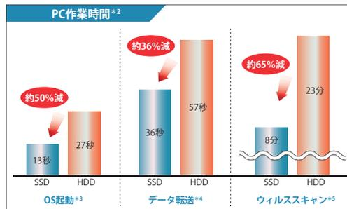
HDDと異なりモーターや磁気ヘッド、回転ディスクなどの機械的に駆動するパーツがないので、省電力かつ軽量、そして、振動や衝撃に強く高信頼です。また、ディスクを回転させるモーターが不要なため、SSD自体の動作音はありません。
