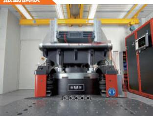
装置に振動を加えた後、正常に動作することを検証
