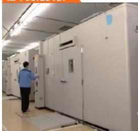
高温高湿状態での加速試験により、部品品質の信頼性を評価
