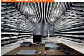
稼働時に装置より発生する電波を測定し、VCCI等の規格に適合することを検証
