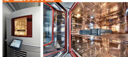
高温または低温状況下でのランニング試験、低湿度または高湿度でのランニング試験による評価
