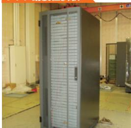
合成地震波試験による震度5の揺れで、壊れず、業務再開可能を検証
