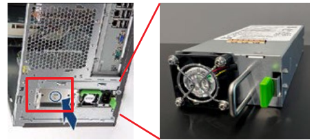
冗長電源スロット 内蔵型バッテリーユニット (250W)
