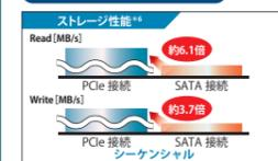
バリューシリーズは、「PCIe接続」による高速SSDが標準搭載です。<sup>\*7</sup>従来の「SATA接続」のSSDよりシーケンシャルリードで約6倍以上、シーケンシャルライトで約3.7倍以上速い圧倒的な性能を実現しています。
