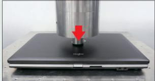
◀液晶パックカバーへの一点加圧試験
